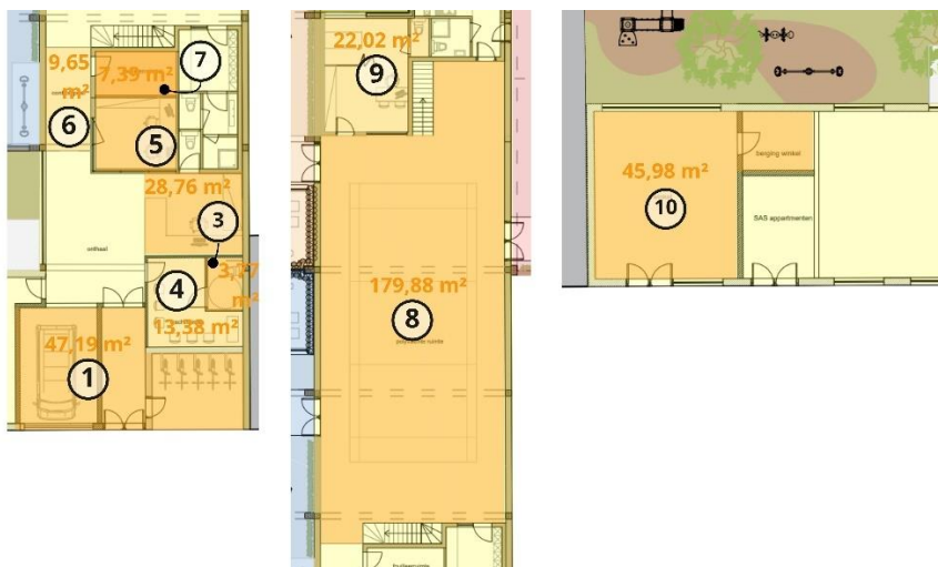
Afb. 58 : Oppervlakten algemene ruimtes Tonniau - Vanmeirhaeghe
